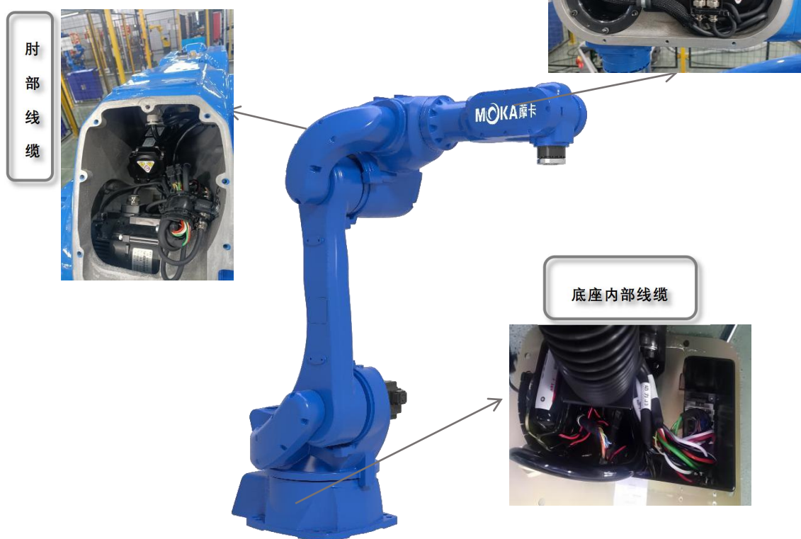
● MR30-1700 机器人线缆布局示意图
