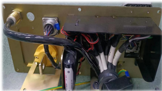
● 机器人 J1、J2 电机连接处
